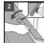
À l'aide d'un ciseau, retirez la languette de la planche, puis appliquez de la colle à bois sur le côté long et faites glisser les planches ensemble horizontalement. Placez des cales d'espacement entre la dernière planche et le mur et ne les retirez que lorsque la colle a durci et séché.
