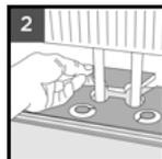
Percez des trous de deux fois plus grand que le diamètre des tuyaux. Découpez un morceau de la planche avec un outil approprié. Placez ensuite la planche d'un côté des tuyaux et réinsérez le morceau précédemment découpé de l'autre côté.
