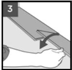
Lors de l'emboîtement, il est important de commencer par le coin de la lame précédente, en rabaisant vers le centre et continuer vers le long du côté opposé. Pendant l'emboîtement, veillez à ce que les lames soient serrées les unes contre les autres.
