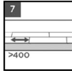
Espacement des jointures décalées, c.-à-d. la distance minimale entre les jointures entre deux rangées ne doit pas être inférieure à 400 mm pour des raisons optiques et techniques.
