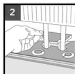
Bohren Sie Löcher, die doppelt so groß sind wie der Durchmesser der Rohre. Entfernen Sie ein Teilstück des Bretts mit einem geeigneten Werkzeug. Anschließend legen Sie das Brett auf eine Seite der Rohre an und fügen das zuvor entfernte Teilstück auf der anderen Seite wieder ein.
