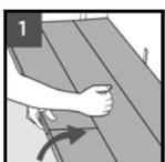
Trennen Sie die komplette Reihe, indem Sie sie über die gesamte Länge vorsichtig anheben. Die ganze Reihe hochklappen und aufnehmen.
