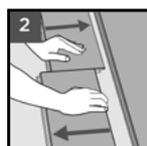
Demontieren Sie die einzelnen Bretter, indem Sie die kurzen Enden horizontal auseinander schieben.
