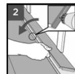
Entfernen Sie die Feder des Bretts mit einem Stechbeitel, tragen Sie dann Holzleim an der Längsseite auf und schieben Sie die Bretter horizontal zusammen. Platzieren Sie einige Abstandskeile zwischen der letzten Diele und der Wand und entfernen Sie diese erst wieder, wenn der Leim ausgehärtet und getrocknet ist.
