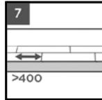
Versetzter Fugenabstand, d. h. der Mindestabstand der Stöße zwischen zwei Reihen sollte aus optischen und technischen Gründen nicht kleiner als 400 mm sein.
